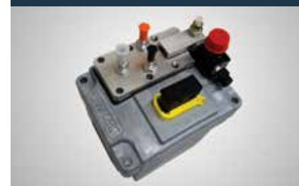
ZAMJENA MODULA AD BLUE TEKUĆINE S ISPIRANJEM D2676 EURO 6 KAMION
